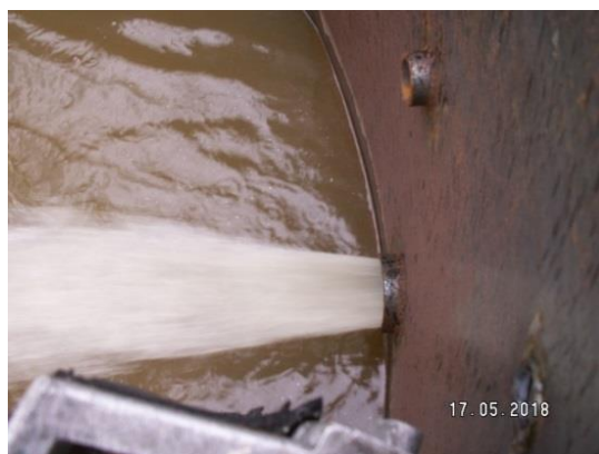
Fot. 4.3. Układ mieszania w reaktorze - tłoczenie czynnika inertnego podczas próby szczelności
