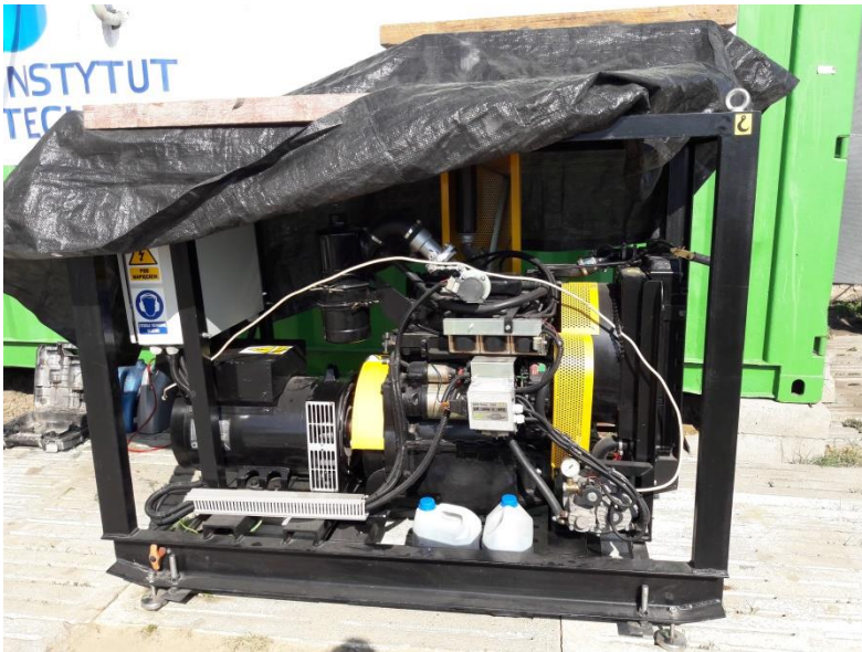
Rys. 32. Kogenerator na biogaz [fotografia G. Wałowski]: a) widok przed montażem, b) widok po montażu.
